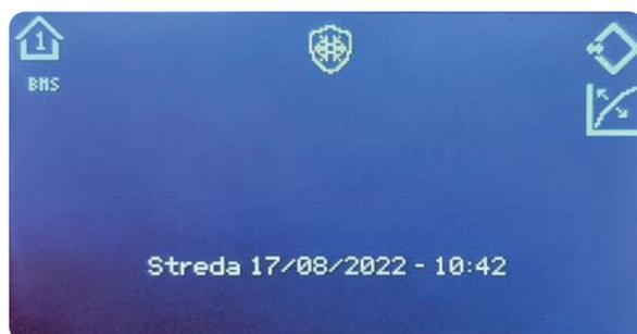
Pokud při aktivním BMS dojde k výpadku komunikace delšímu než 30 sekund bude kotel pod ikonou zón zobrazovat poruchové hlášení (E144) Alarm BMS offline. Chyba bude automaticky resetována jakmile kotel přijme první platnou zprávu od Modbus masteru.
